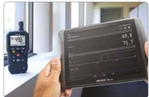
MR77 bei der Übertragung von Daten an ein Android Tablet PC, auf dem FLIR Tools Mobile läuft.
